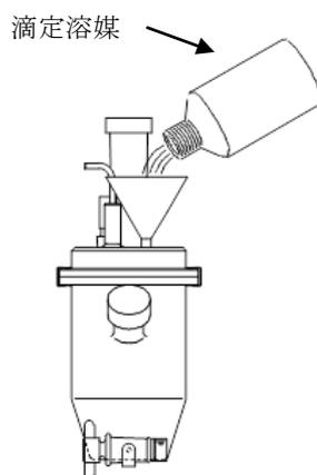
図 3・1 滴定溶媒の注入図
