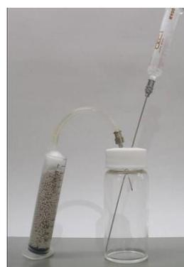
図 5・1 試料採取法の概念図
